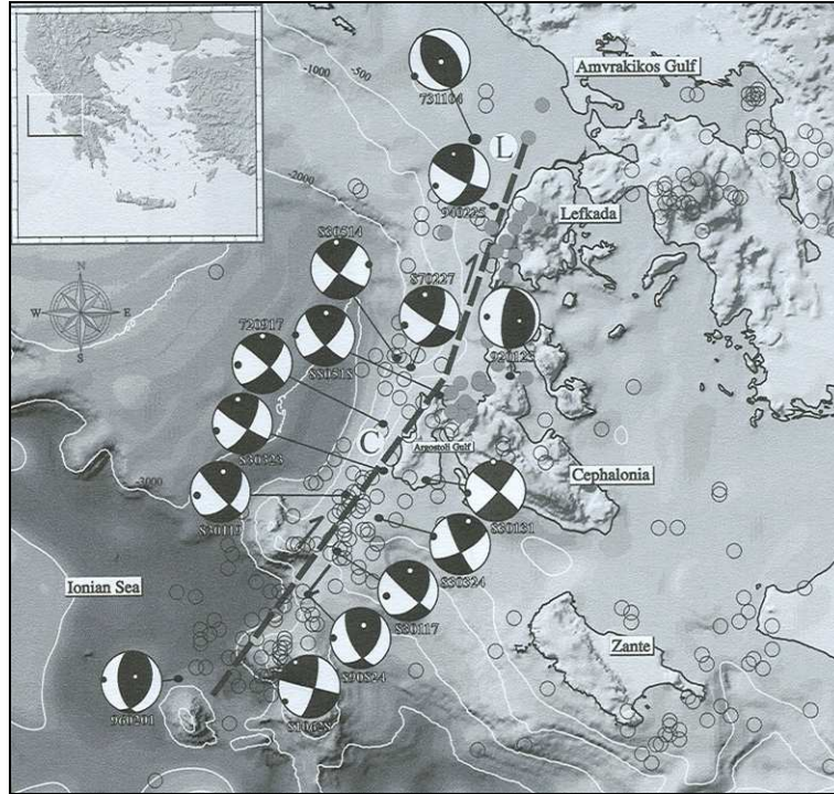
Σχήμα 1. Το υποθαλάσσιο ρήγμα Κεφαλονιάς-Λευκάδας, κοντά στις δυτικές ακτές των νησιών. Απεικονίζονται επίσης με τους μικρούς κύκλους τα σεισμικά επίκεντρα καθώς και οι μηχανισμοί γένεσης των μεγαλύτερων σεισμών (από Louvari et al., 1999).
